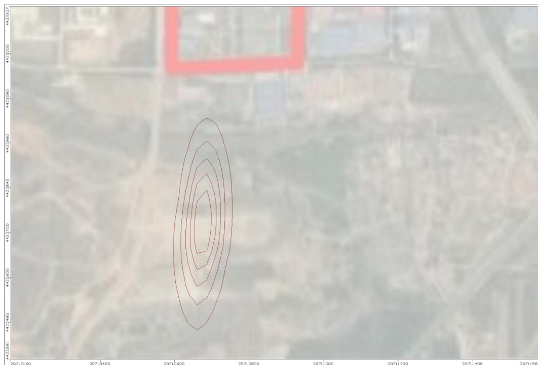
图 5.4-18 废水处理站非正常工况下氨氮污染运移结果图
